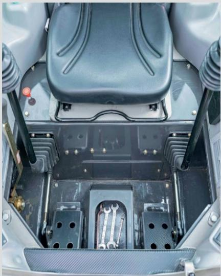
**Рычажное управление гидронасосами хода** погрузчика; простое, привычное (рычагами вперёд-назад), выполнено посредством регулируемых механических тяг через сайлент-втулки. Это даёт отсутствие вибрации на рычагах, комфорт и абсолютную точность управления движением;
