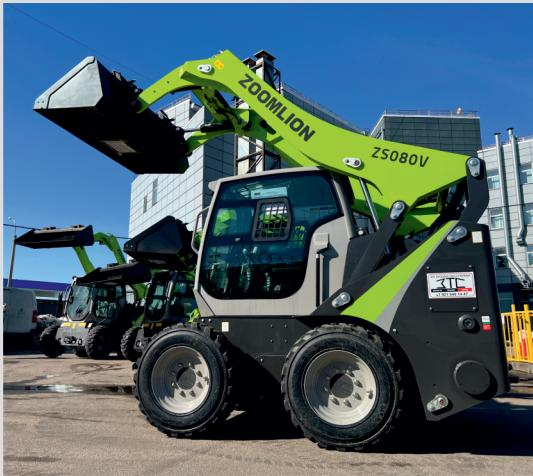
**Конструкция стрелы** – прогрессивная, вертикальный подъём. Что это даёт: когда погрузчик находится в непосредственной близости от объекта (борт самосвала), то вертикальный ход грузовой стрелы значительно облегчает и ускоряет рабочий процесс, так как в наивысшей точке подъёма стрелы ковш уходит за борт машины в кузов (для разгрузки сыпучих) значительно дальше, чем при радиальном подъёме, традиционном для всех прочих китайских производителей;
