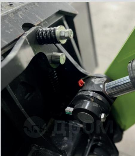
Универсальная монтажная рама «Bob-Tach» с подпружиненными механическими замками, абсолютно идентична аналогичной системе механическойстыковки погрузчика Bobcat с навесным оборудованием:
