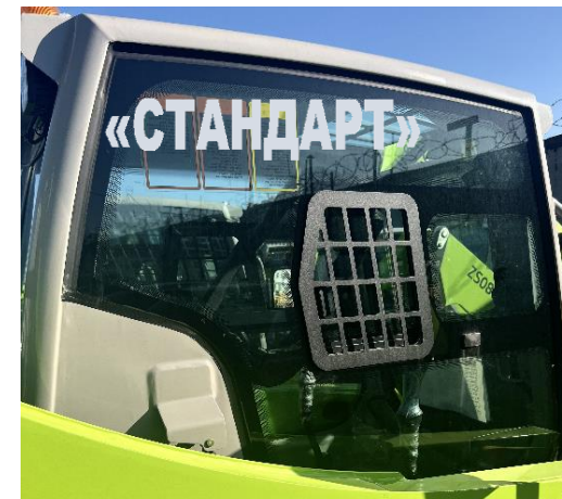
2. Защитные сменные решетки боковых окон (комплектация ZS080V "ФЛАГМАН", "ХАЛК". Комплектация ZS080V "СТАНДАРТ" - защитные решетки только на боковых форточках).
