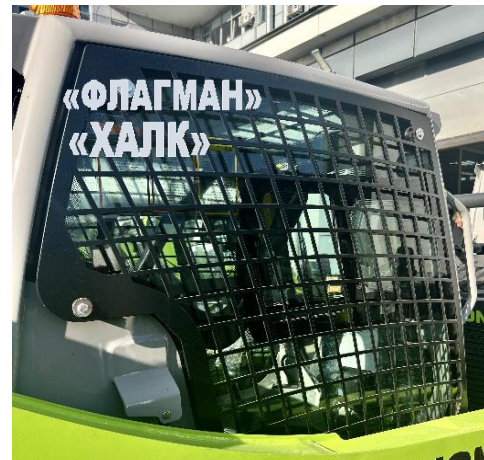
2. Защитные сменные решетки боковых окон (комплектация ZS080V "ФЛАГМАН", "ХАЛК". Комплектация ZS080V "СТАНДАРТ" - защитные решетки только на боковых форточках).
